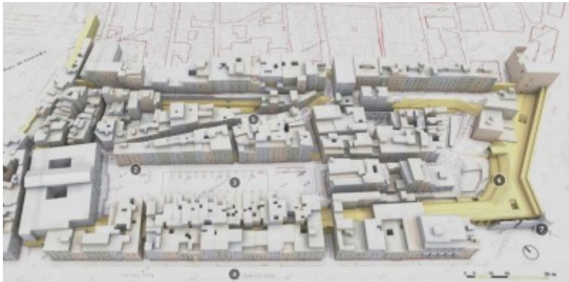
Circ romà de Tarragona. Mostra model mapa de punts obtingut a partir de l'escàner làser. Imatge: ICAC.
