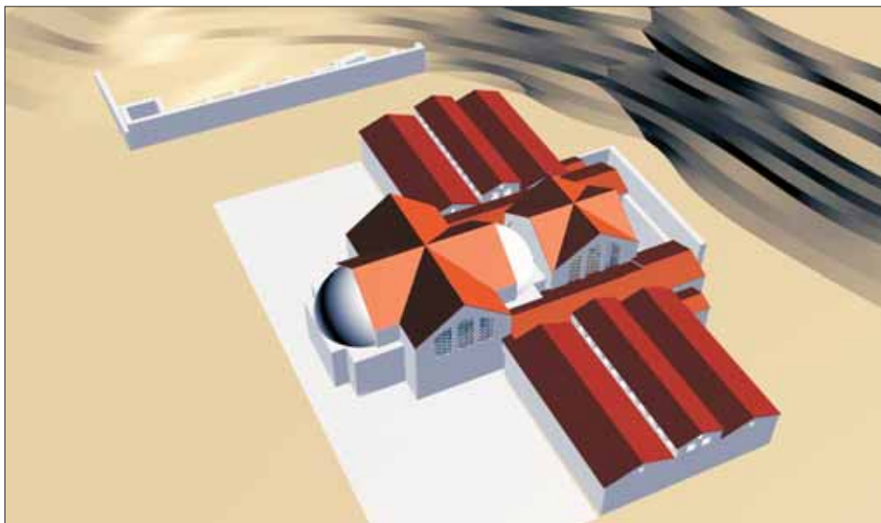
fig. 149: Hipòtesi del sistema global de cobertes
