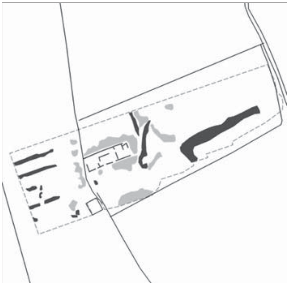
Figura 13. Diagrama d'interpretació derivat dels resultats de la prospecció per resistivitat efectuada a les Bassasses.
