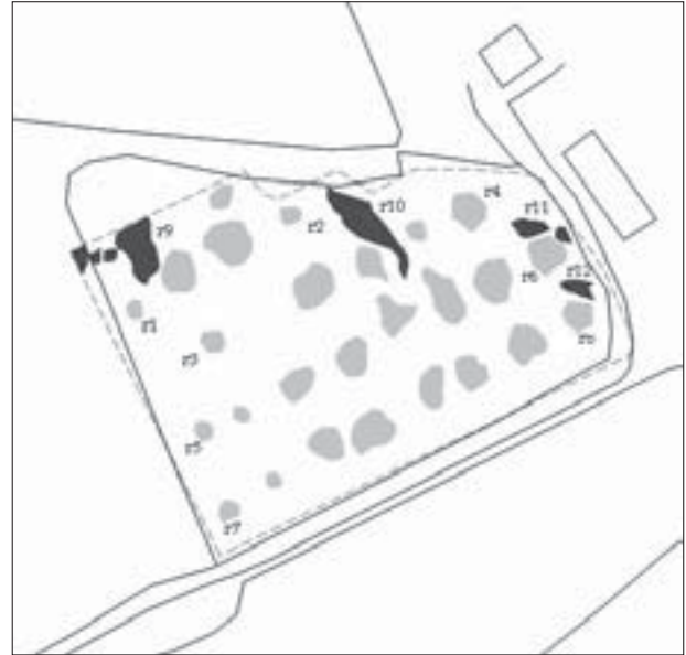
Figura 18. Diagrama d'interpretació derivat dels resultats de l'estudi de resistivitat efectuat al Mas de la Pastora. Figure 18. Interpretation plot derived from the resistivity survey results from Mas de la Pastora.
