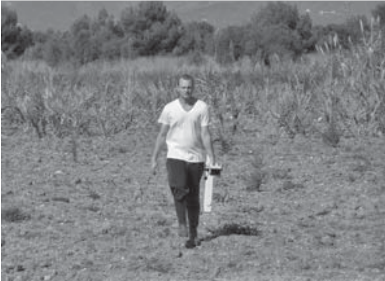
Figura 2. Estudi magnetomètric efectuat als Antigons mitjançant un gradiòmetre de vàlvules de flux FM36 (foto: Rob Fry).
