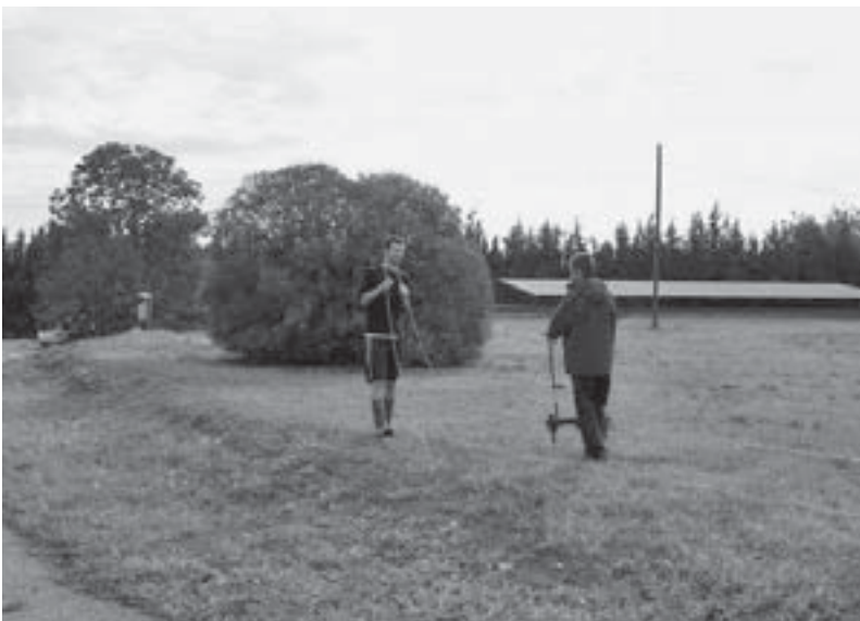
Figura 3. Prospecció pel sistema de resistivitat efectuat a Centcelles mitjançant un mesurador de resistència RM15 (foto: Rob Fry).
