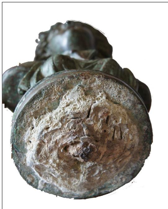
Figura 4. Vista de la base del contrapeso con elemento central de hierro ensartado tomado con plomo fundido. Las marcas de navaja fueron realizadas en el momento del hallazgo en los años 1970 para comprobar la profundidad del plomo.
