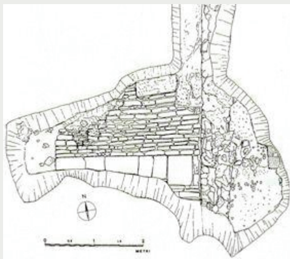
Figura 15. Acelum : tratto della via Aurelia pavimentato con la tecnica detta "a traversine" (da ROSADA 1999).
